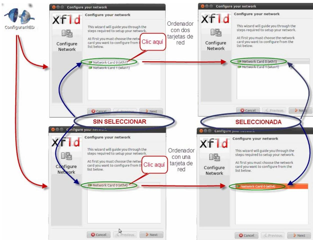
Hay que hacer doble clic en el icono ConfigurarRED y se muestra una ventana que nos permite configurar la o las tarjetas de red que tengamos en nuestro ordenador. Las imágenes de arriba muestran dos tarjetas (una cableada –la rodeada con una línea verde– y otra inalámbrica) y las de abajo una sola tarjeta. **En cualquier caso, aunque sólo se muestre una tarjeta, hay que hacer “clic” con el ratón sobre ella para marcarla y proceder a su configuración.**
